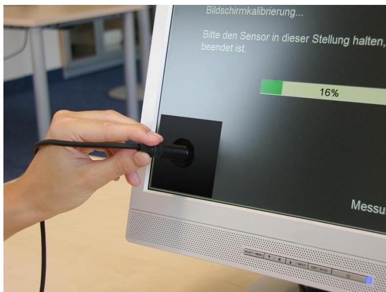
Obraz 2: Kalibrace monitoru pomocí kalibrovacího zařízení. Kalibrace VTS by se měla provádět jednou za půl roku nebo po výměně hardwaru (např. nový monitor).
